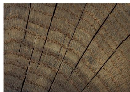
Abb. 5: Detailaufnahme (Querschnitt), unbehandelte Holzoberfläche der Weißbeiche (Kernholz) nach ca. 12 Monaten Bewitterung mit deutlicher Rissbildung.
