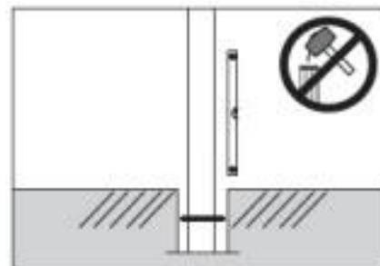
Warten Sie, bis der Beton ausgehärtet ist, bevor Sie mit Schritt 2 fortfahren. Wenn Sie die Pfosten mithilfe von Pfostenhalterungen auf hartem Untergrund oder einem Fundament montieren, können Sie sofort mit Schritt 2 fortfahren.
